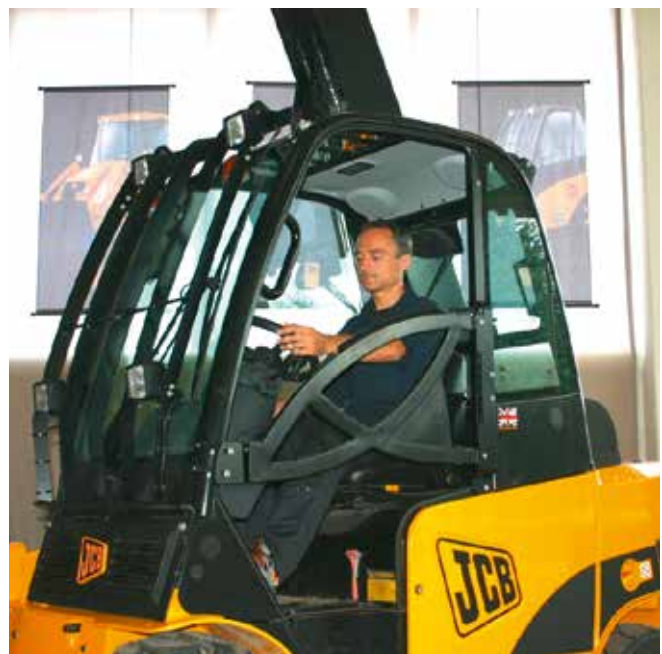
Bild 2-7: Bügeltüren als Rückhalteeinrichtung.
