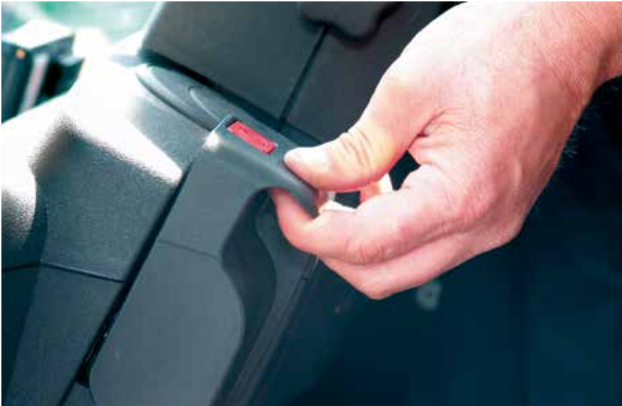
Bild 7-2: Durch Anziehen der Feststellbremse wird der Gabelstapler gegen unbeabsichtigte Bewegungen gesichert
