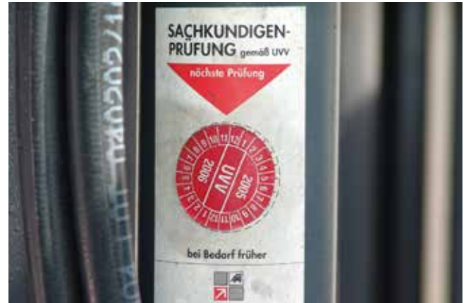
Bild 5-2: Die Prüfplakette erleichtert es dem Fahrer, die Prüffristen zu überwachen
