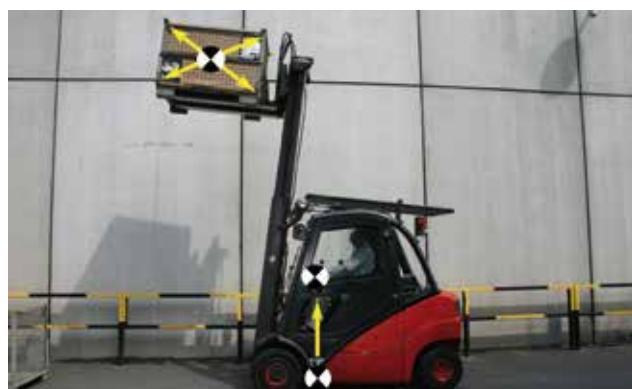
Bild 6-22: Verlagerung des Gesamtschwerpunktes bei angehobener Last
