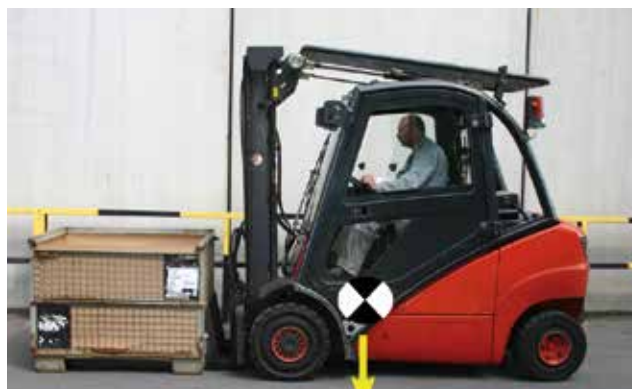
Bild 6-21: ... ergeben den Gesamtschwerpunkt bei abgesenkter Last
