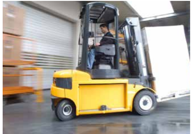
Bild 6-17: Gabelstapler mit drehbarer Fahrerkabine – System „Jungheinrich“
