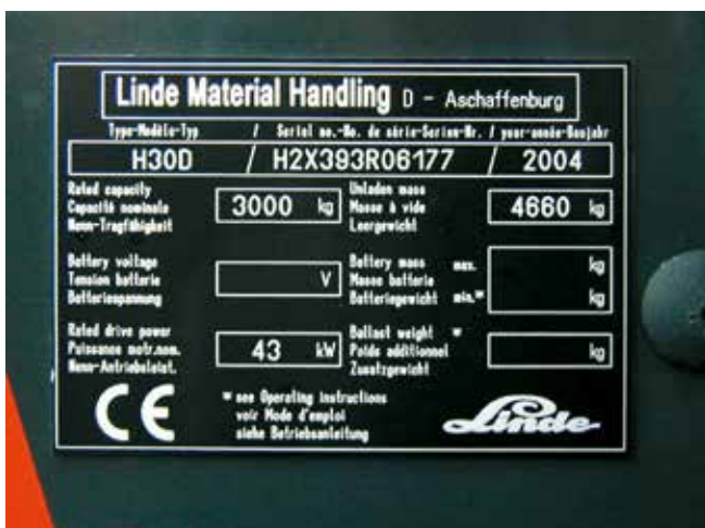
Bild 2-1: Fabrikschild mit CE-Zeichen für ein Flurförderzeug
