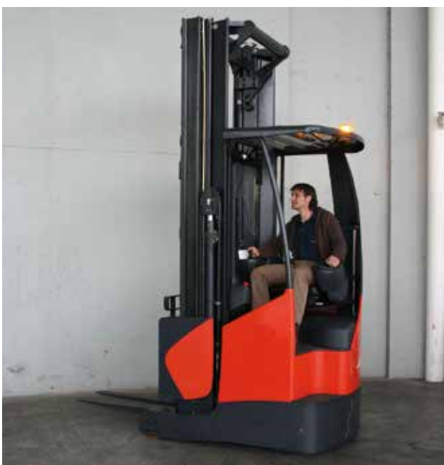
Bild 6-16: Für regelmäßiges Rückwärtsfahren geeigneter Quersitzstapler
