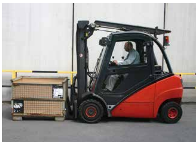
Bild 6-9: Damit der Lastschwerpunkt in der Nähe der Vorderachsen liegt, Last immer so aufnehmen, dass sie am Gabelrücken anliegt
