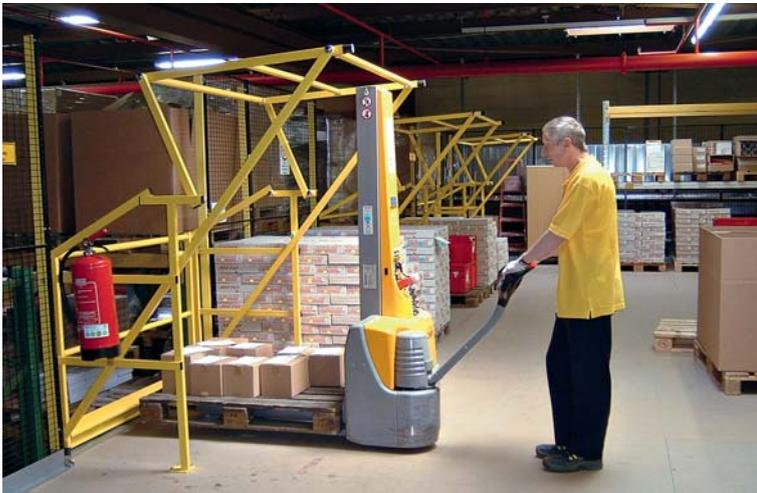
Schwenkbare Geländer zur Absicherung an einer Lagerbühne
