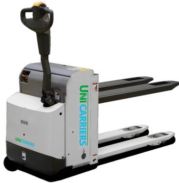
Der schmale und wendige Gabelhubwagen mit seiner seitlich versetzten Deichsel ermöglicht optimales Arbeiten auf Laderampen und Lastwagen, in der Produktion, im Geschäft und in kleinen Lägern. Auch bei engsten Verhältnissen. Der Gabelhubwagen hat zusätzlich zum Radarmhub einen Kommissionierhub um Lasten auf die optimale Greifhöhe zu bringen.
