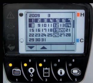
Aufzeichnungsfunktion der Maschinendaten
