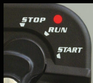
LED – Warnanzeige bei aktiviertem Diebstahl - System
