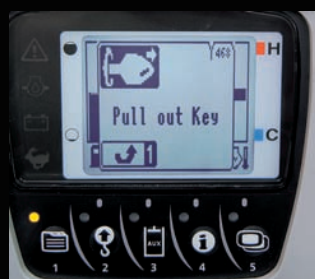
Informations – Alarm bei im Zündschloss befindlichen Schlüssel
